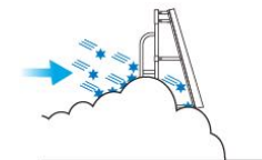
下部間隙閉塞時、柵風上に雪粒子を捕捉
