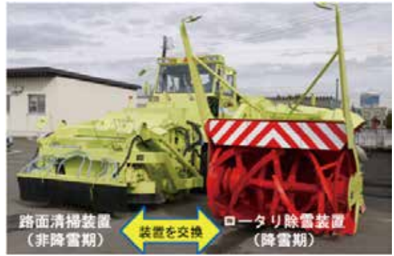
アタッチメント式路面清掃装置
