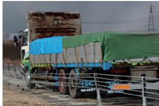
コンクリート舗装への設置仕様の開発 ワイヤー式防護柵の大型衝突試験
