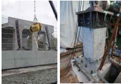
落石防護柵の実規模衝突実験 橋脚の耐震性能実験
