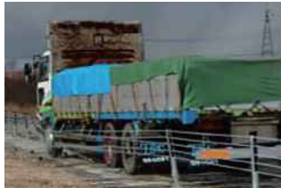
コンクリート舗装への設置仕様の開発 ワイヤロープ式防護柵の大型車衝突試験
