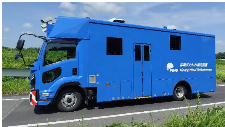
MWDの外観 ※中型車(8t)を採用
