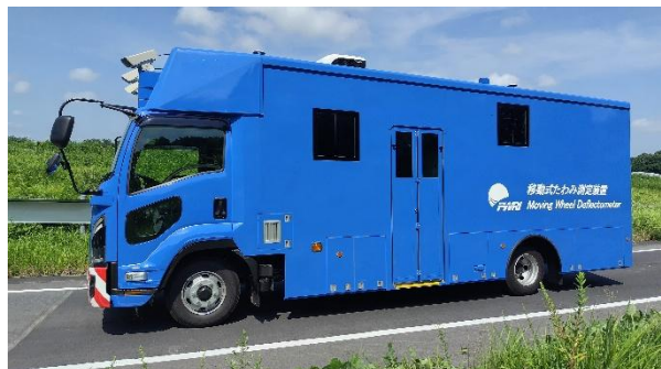
載荷装置 中型車両(輪荷重約2.5t)
