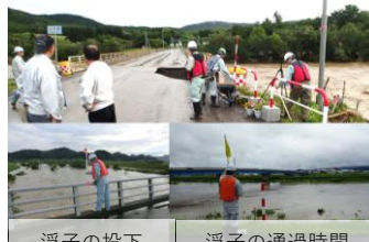
浮子の投下 現在の洪水時の流量観測 浮子の通過時間から流速算定
