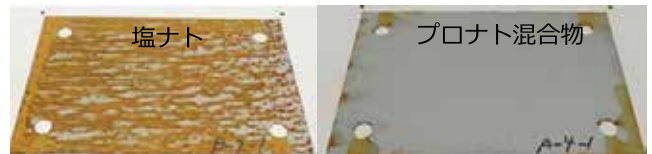
試験片の金属腐食状況（北陸東海自動車道での比較試験）
