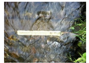
掃流砂の計測（ハイドロフォン）
