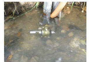
浮遊砂の計測（濁度計）
