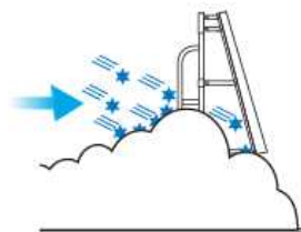
下部間隙閉塞時、柵風上に雪粒子を捕捉
