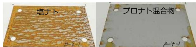
試験片の金属腐食状況（北陸東海自動車道での比較試験）
