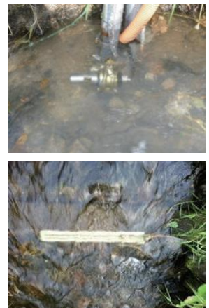
掃流砂の計測（ハイドロフォン）
