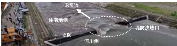
実物大規模の堤防決壊実験（北海道開発局と共同で実施）
