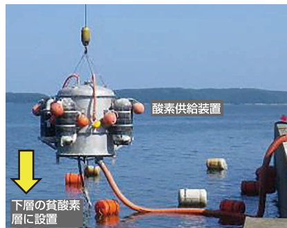
酸素供給装置による汽水湖水質改善現地試験の様子(網走湖)
