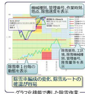
グラフ化機能で表した除雪作業
