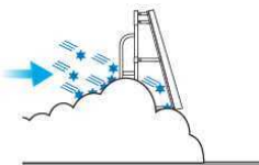
下部間隙閉塞時、柵風上に雪粒子を捕捉
