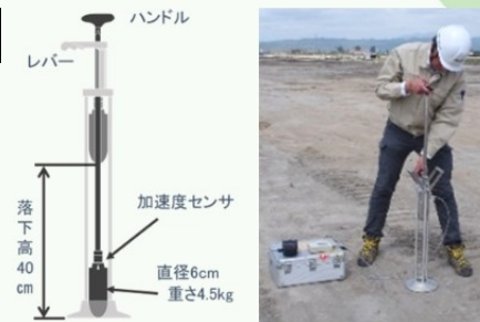
衝撃加速度試験装置
