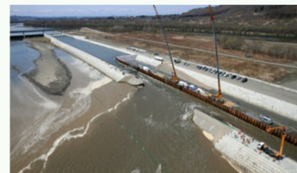
実物大規模の越水破堤実験
