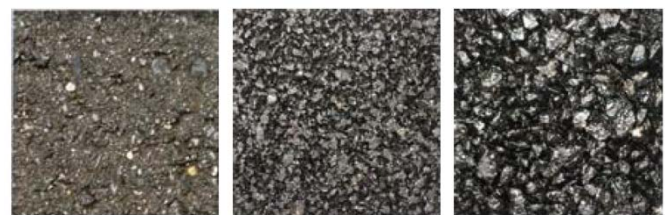
舗装表面の比較 （左から、密粒度舗装、低燃費舗装、排水性舗装）
