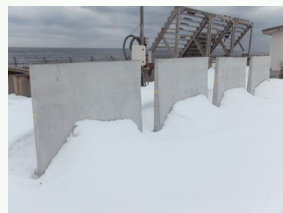
リサイクル骨材を使用したプレキャスト擁壁の暴露試験
