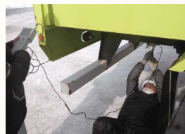
センサーによる除雪トラックのフレーム劣化度試験測定
