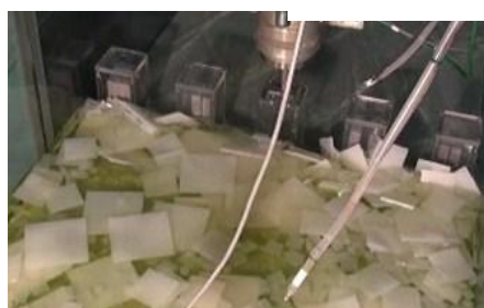
断面水路・平面水槽による氷+津波の混相流体の実験
