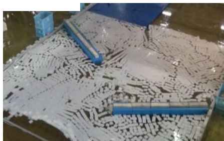
断面水路・平面水槽による氷+津波の混相流体の実験
