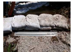
掃流砂の計測（ハイドロフォン）
