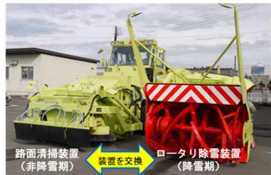
アタッチメント式路面清掃装置
