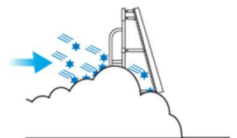
下部間隙閉塞時、柵風上に雪粒子を捕捉
