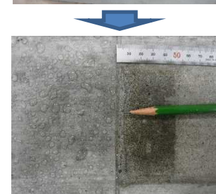
測定面の撥水域を測定して 吸水防止層の形成を確認
