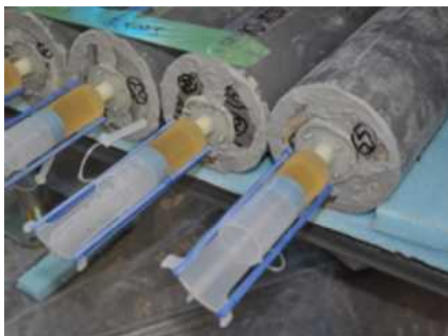
樹脂系注入材の注入試験 (φ10×20cm円柱供試体)
