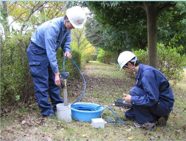
孔内傾斜計の測定状況
