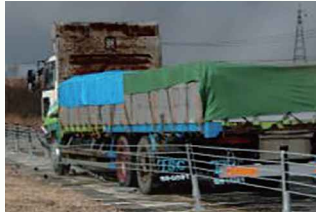
コンクリート舗装への気圧仕様の鋼材ワイヤーロープ式防護柵の大型車衝突試験
