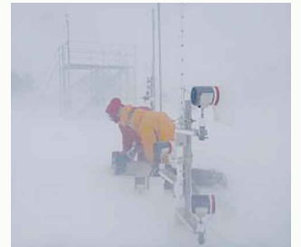
地吹雪時の現地人力観測 (於：寒地土木研究所石狩吹雪実験場、吹雪推定手法の基礎データの収集)
