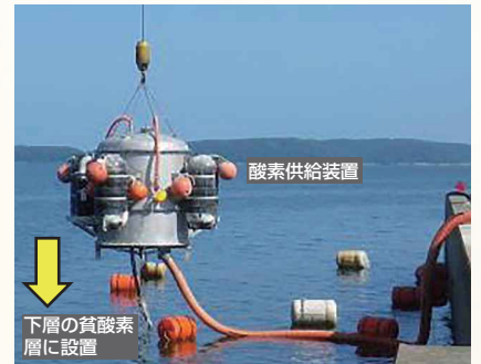
酸素供給装置 酸素供給装置による 汽水湖水質改善現地試験の様子(網走湖)
