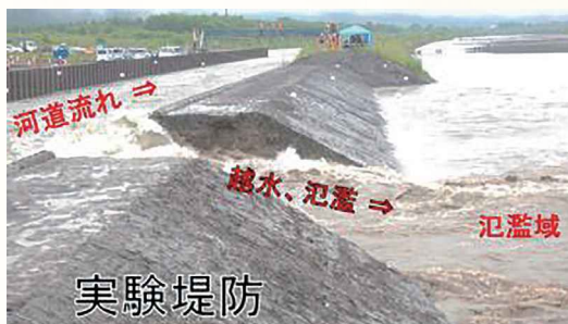
実物大規模の堤防決壊実験
