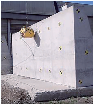
落石防護擁壁の実規模衝突実験
