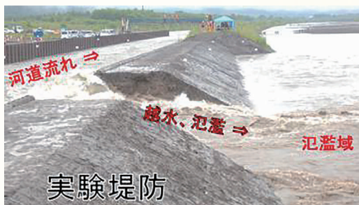
実物大規模の堤防決壊実験
