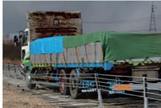
コンクリート舗装への気圧試験の開始 ワイヤーロープ式防護柵の大型車衝突試験
