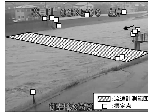
評定点をセットしたCCTVカメラ画像の一例
