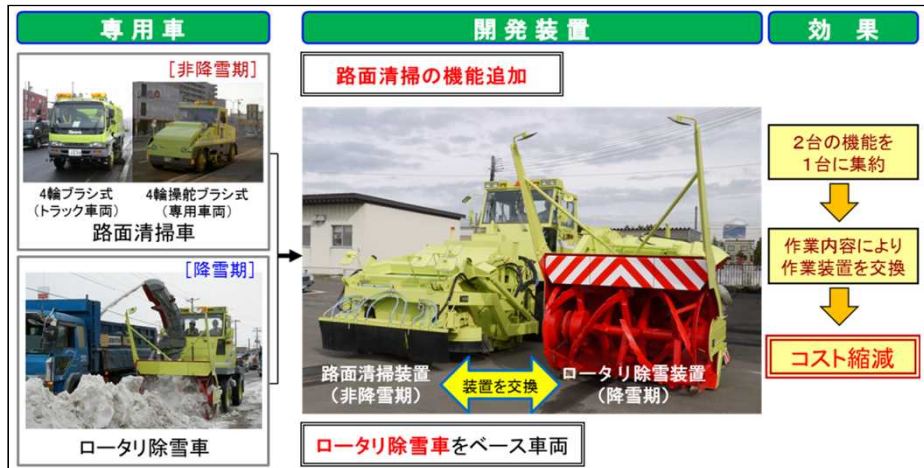
ロータリ除雪車の多機能化(路面清掃機能付加)
