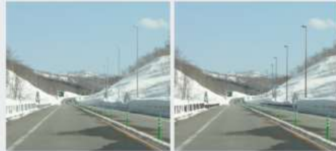
色彩シミュレーション。左の垂鉛めっき仕上げ(実物)よりも、右のこげ茶系の色彩(フォトモニター)のほうが、照明柱や防護柵が目立って見える。
