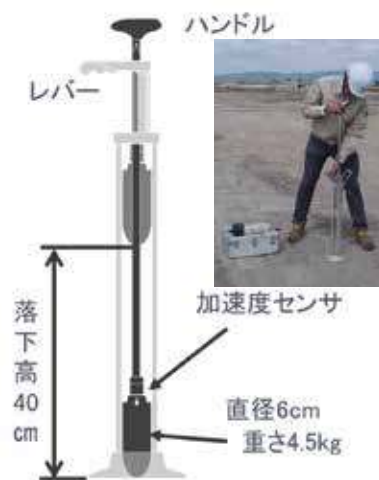
衝撃加速度試験装置
