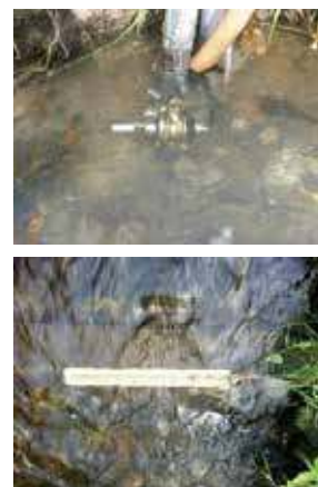
掃流砂の計測 (ハイドロフォン)
