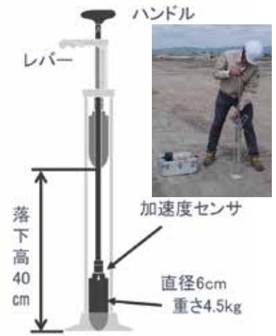
衝撃加速度試験装置
