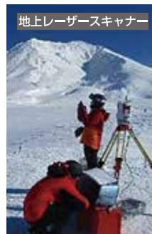
地上レーザースキャナー 高山帯における 高精度積雪分布調査（旭岳）
