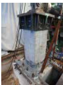
橋脚の耐震性能実験
