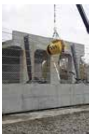
落石防護柵の実規模衝突実験
