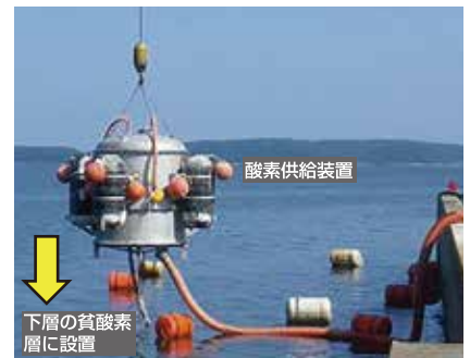
酸素供給装置による 汽水湖水質改善現地試験の様子（網走湖） 酸素供給装置 下層の貧酸素層に設置
