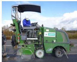
▲ ランブルストリップス施工専用機
