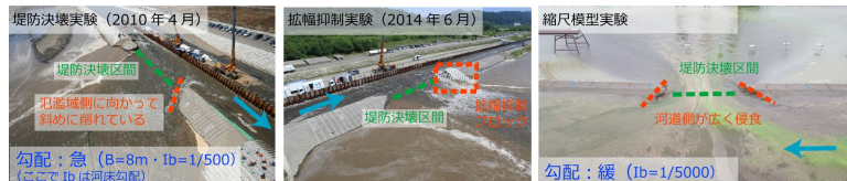
千代田実験水路における実物大規模の実験(左・中央)、河道特性を変えた縮尺模型実験(右)
