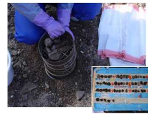
個別衝突試験用の礫の採取
