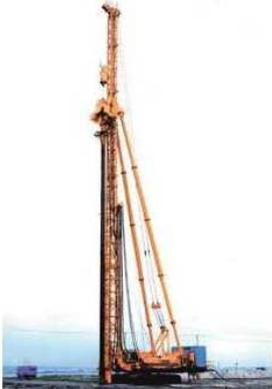
施工機姿図（振動締固タイプ）
