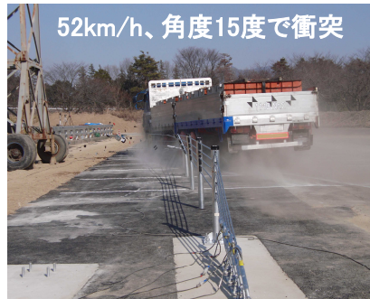
▲乗用車(1トン)のAm種試験 ▲大型車(20トン)のAm種試験 ▲衝突後の乗用車損傷状況
