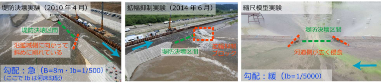
千代田実験水路における実物大規模の実験(左・中央)、河道特性を変えた縮尺模型実験(右)
