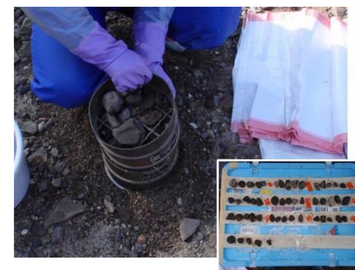
個別衝突試験用の礫の採取
