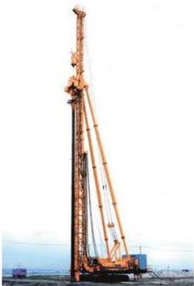
施工機姿図（振動締固タイプ）
