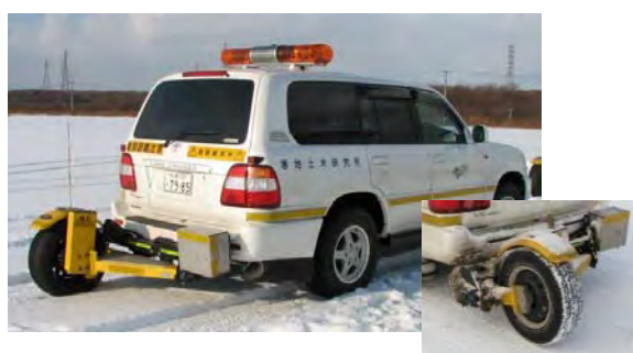
写真1 路面すべり抵抗値測定装置(通称:CFT)
