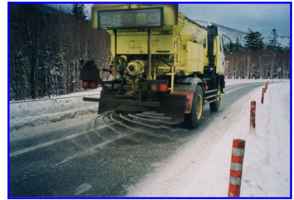
写真(左) 表面が雪水で覆われた日本海沿岸の覆道 写真(右) 凍結防止剤の散布状況(内陸でも塩害が懸念される)
