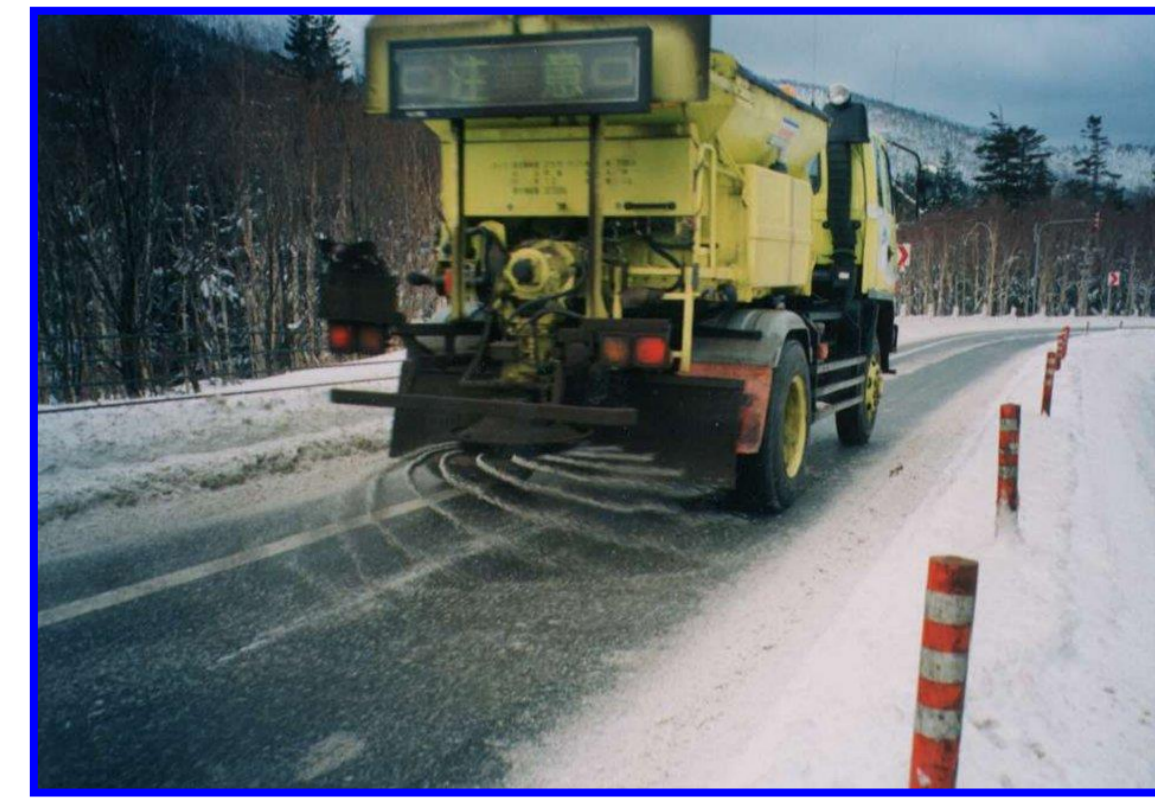
写真(左) 表面が雪氷で覆われた日本海沿岸の覆道 写真(右) 凍結防止剤の散布状況(内陸でも塩害が懸念される)
