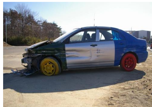
▲乗用車(1トン)のAm種試験 ▲大型車(20トン)のAm種試験 ▲衝突後の乗用車損傷状況
